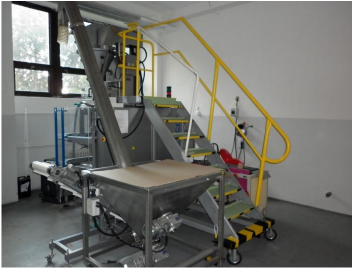
Vertikálny hadicový baliaci stroj VELTEKO CZ s.r.o. – HSV 101 B Flexible
